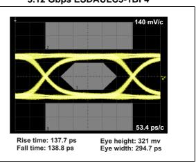
Figure 14. Eye diagram USB2.0, 480 Mbps ESDAULC5-1BF4
